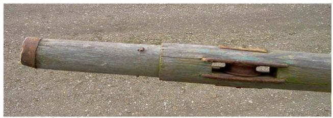
Détail de la tête de mât. On remarque le "collet" et la "fusée" sur lesquels viendront s'appuyer les haubans. L'extrémité du mât, percée pour recevoir une girouette, est renforcée d'un frêtage métallique pour éviter l'éclatement comme le montre le dessin ci-dessous réalisé par François Ayrault. On remarquera que le capelage des 2 paires de hautbans et de l'étai est également représenté.
