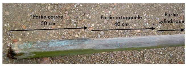
Le "collet" du mât (là où s'appuient les haubans) est à 5,4 m, la fusée au-dessus fait 24 cm. Le diamètre, qui est encore de 7,5 cm à 3,4 m, tombe à 5,5 cm au collet. La fusée terminale
